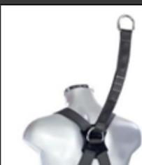
Die Verlängerung an der Rückenöse darf nur zusammen mit einem Höhensicherungsgerät nach EN360 verwendet werden! Die Benutzung zusammen mit einem Verbindungsmittel mit Bandfalldämpfer ist ausnahmsweise erlaubt, aber nur dann, wenn die Gesamtlänge des Verbindungsmittels **150 cm nicht überschreitet!**
