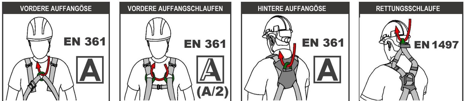
Die vordere Auffangöse der Gurttypen V33, V34, ist ein runder Metallring (Alu oder Stahl), mit „A“ gekennzeichnet. Die Modelle V3, V20 und C3 haben im Brustbereich zwei textile Auffangschlaufen beide mit „A/2“ gekennzeichnet. Diese Schlaufen dürfen nur zusammen verwendet werden. Die Auffangösen und Auffangschlaufen dieser Gurte dürfen lediglich in Verbindung mit folgenden Elementen und Geräten verwendet werden:
